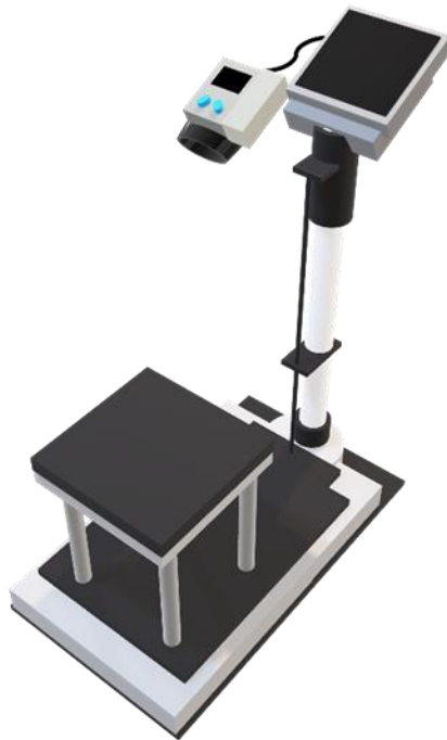
Gambar 1. Desain Sistem Pengukuran Berat Badan dan Tekanan Darah
