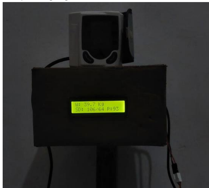
Gambar 11. Tampilan hasil pengukuran pada LCD
