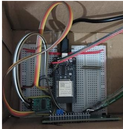
Gambar 10. Pengkabelan pada ESP32
