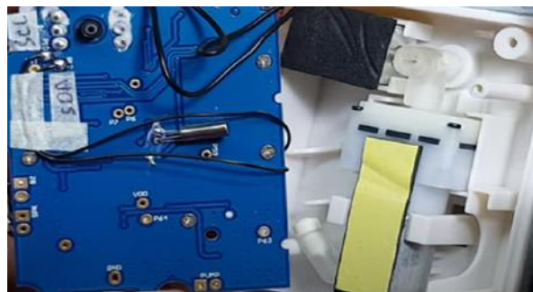
Gambar 9. Rangkaian pengukur tekanan darah
