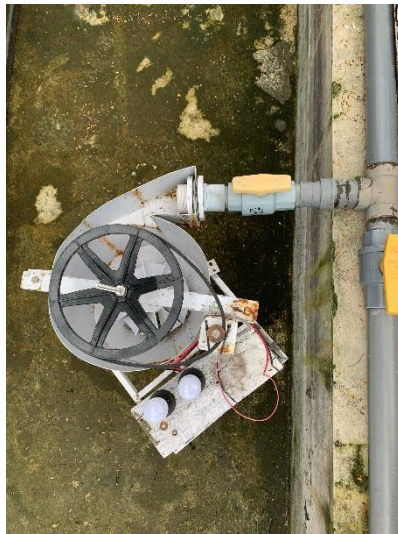
Gambar 5. Realisasi Prototipe PLTMH
