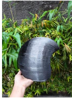
Gambar 12. Helm arah serat 0° dengan fraksi volume 46%
