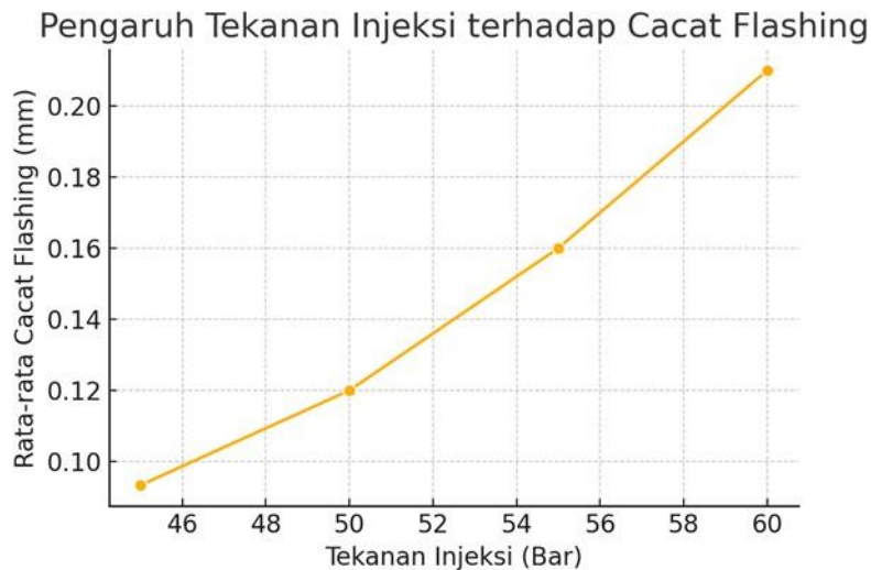
Gambar 4. grafik pengaruh tekanan inject 3 terhadap cacat flashing
