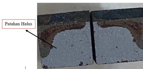
Gambar 8. Hasil patahan dengan menggunakan air garam dengan kadar 10%
