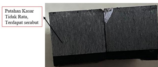
Gambar 9. Hasil patahan dengan menggunakan Oli SAE 40
