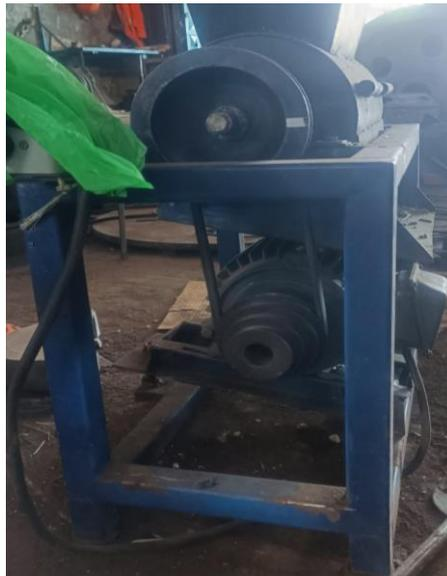
Gambar 3. Proses Pengaturan Kecepatan Putar
