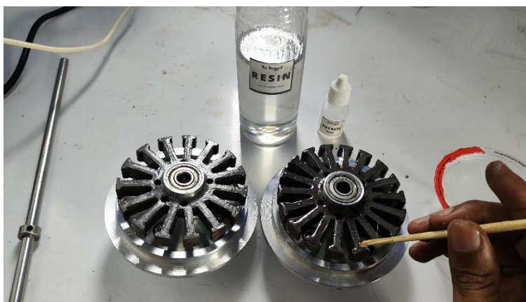
Gambar 4. Pelat stator setelah di lem dan di pres
